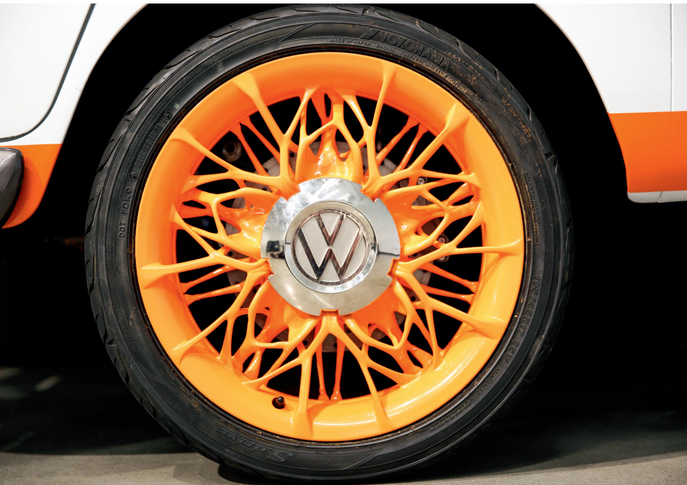
Designoptimierte Felgen: Sie machen den Bulli erheblich leichter und verringern den Rollwiderstand der Reifen. (© Volkswagen US)
